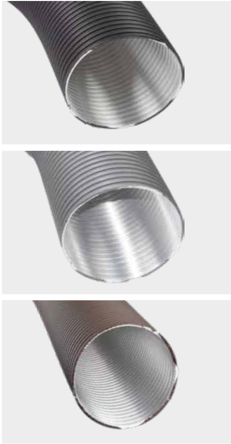
CB ALUFLEXROHR 2-lagig, ausgezogene Länge 150 cm (gestaucht 60 cm)
