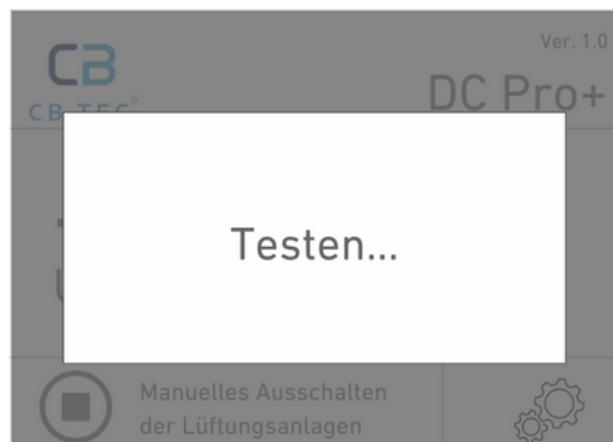
**Druckmessfehler** - Drücken Sie die Taste **Bestätigen** auf dem LCD, die die Diagnostik auslöst. Auf dem LCD wird die Anzeige **Testen** angezeigt. Nach dem Testen kehrt die Elektronik in den Normalmodus zurück. Falls nicht, und das LCD erneut die gleiche Fehlermeldung anzeigt, bitte Service anrufen.
