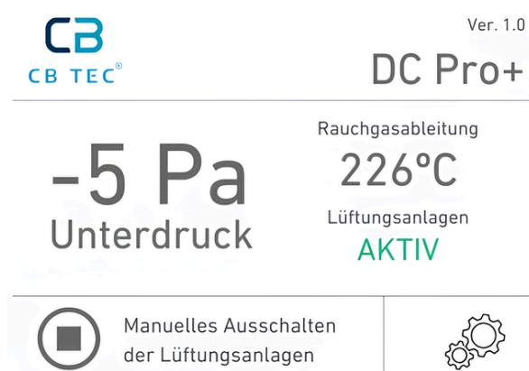
Wird der gemessene Differenzdruck den Grenzwert von -4 Pa steigend zu den **MINUS** Werten überschreiten (d.h. -5 Pa, -6 Pa, -7 Pa...) wird der DC Pro+ nach einer Wartezeit (30 - 120 Sekunden), das Relais automatisch wieder einschalten, d.h. die Relaiskontakte aktivieren sich und auf dem LCD wechselt der Status der Lüftungsanlagen vom **STOP** zum **AKTIV**.
