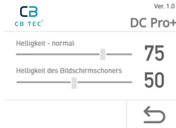
Durch Betätigen der Taste wird **Helligkeit des LCD** im Standardmodus und im Sparmodus eingestellt. Um die Werte einzustellen, ziehen Sie mit dem Finger über die Oberfläche des LCDs, bis die gewünschten Werte auf der rechten Seite des LCDs eingegeben sind. Intervall für den Standardmodus ist 5 - 100 % und für den Sparmodus 0 - 100 %. Nach Eingabe der Werte drücken Sie die Taste
