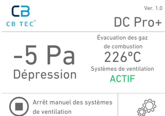
Si la pression différentielle mesurée dépasse la valeur limite de -4 Pa en augmentant vers les valeurs **NÉGATIVES** (c'est-à-dire -5 Pa, -6 Pa, -7 Pa...), , le DC Pro+ réactivera automatiquement le relais après un délai d'attente (30 à 120 secondes), c'est-à-dire que les contacts du relais s'activeront et que l'état des systèmes de ventilation passera de **STOP** à **ACTIF** sur l'écran LCD.
