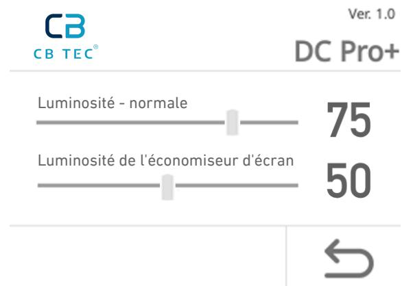
Appuyez sur la touche pour régler **la luminosité de l'écran LCD** en mode standard et en mode économie d'énergie. Pour régler les valeurs, faites glisser votre doigt sur la surface de l'écran LCD jusqu'à ce que les valeurs souhaitées s'affichent à droite de l'écran. L'intervalle pour le mode standard est de 5 à 100 % et pour le mode économie d'énergie de 0 à 100 %. Après avoir saisi les valeurs, appuyez sur la touche .
