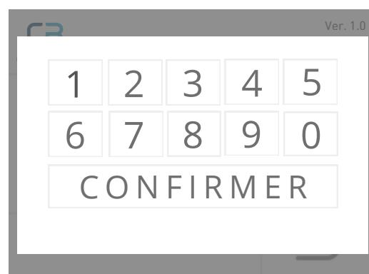
Le **réglage d'usine** des temps d'attente pour l'activation ou la désactivation du relais est prétréglé sur **40 secondes**. La **plage de réglage** est comprise entre 30 et 120 secondes. Pour modifier les valeurs, faites glisser votre doigt sur la surface de l'écran LCD jusqu'à ce que vous ayez saisi les valeurs souhaitées sur le côté droit de l'écran LCD. Après avoir saisi les valeurs, appuyez sur la touche .
