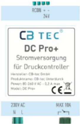
Schalteinheit (Netzteil und Relaiseinheit)
